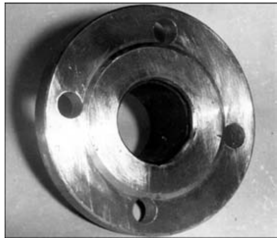
Рис. 3. Внешний вид соединения вкладной трубки с фланцем
