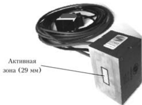
Рис. 7. УЗ преобразователь ФАР системы FFAST II
