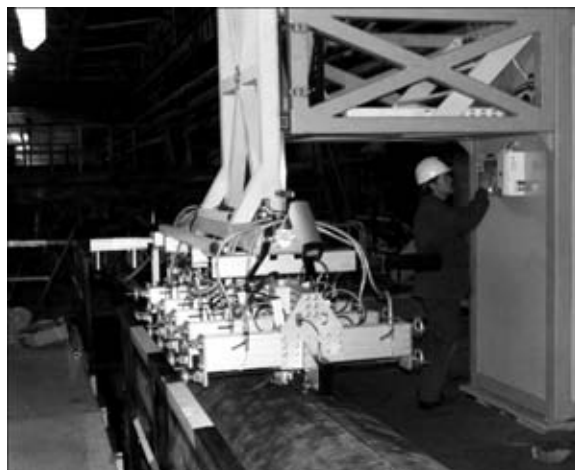
Рис. 1. Установка НК 360 для АУЗК продольных сварных швов труб
