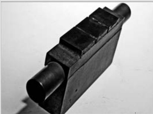
Паяная модель узла дивертора установки термоядерного синтеза (соединение медь — вольфрам)
