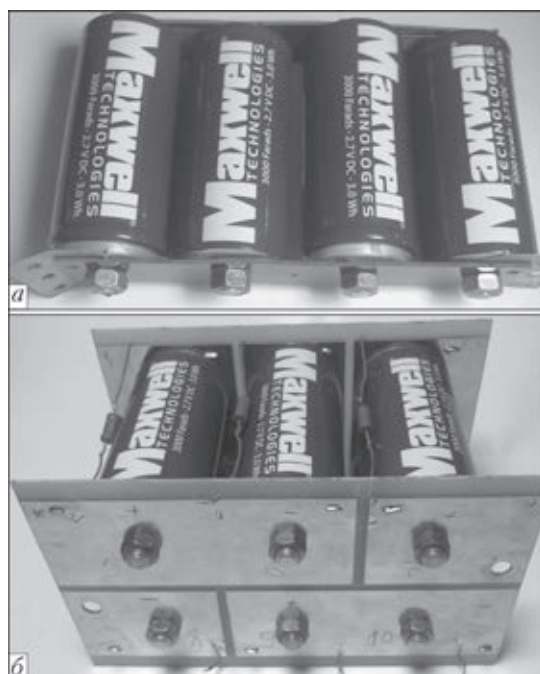
Рис. 1. Примеры выполнения последовательной БСК на основе 4-х (а) и 6-ти (б) ячеек
