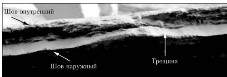
Рис. 2. Трещина в наружном продольном шве разрушившейся трубы диаметром 820 мм
