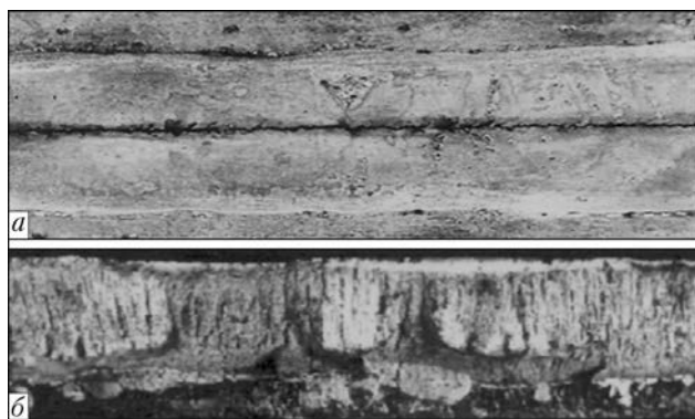
Рис. 5. Продольная трещина в наружном шве трубы из стали 14ХГС, обусловленная действием преимущественно силового фактора: а — вид со стороны наружного шва; б — поверхность излома
