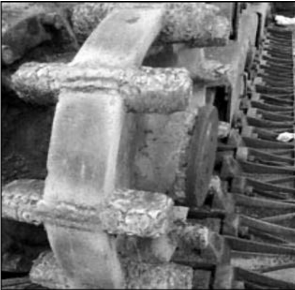
Рис. 4. Внешний вид восстановленной ведущей звездочки крана КС8165
