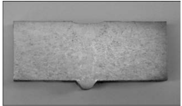
Рис. 5. Макрошлиф сварного соединения сплава 1, выполненный ЭЛС с предварительным подогревом 200 °С и последующей ЛТО
