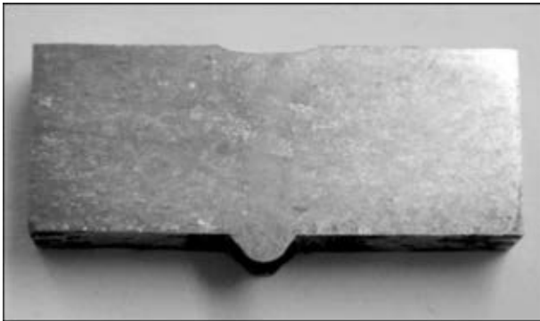
Рис. 4. Макрошлиф сварного соединения сплава 1, выполненный ЭЛС с предварительным подогревом 200 °С
