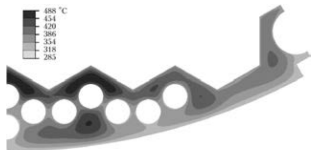
Рис. 7. Распределение температуры в выгородке реактора при работе на максимальной мощности
