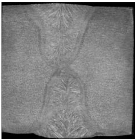
Рис. 6. Металл шва, сваренный под флюсом АН-47ДП с проволокой ИМТ 9 (пять проходов с каждой стороны)
