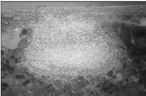
Рис. 8. Макроструктура (X5) металла наплавленного слоя меди М1
