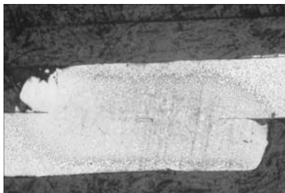
Рис. 6. Макрошлиф ( \times 50 ) сварнопаяного соединения по сечению вблизи центра соединения
