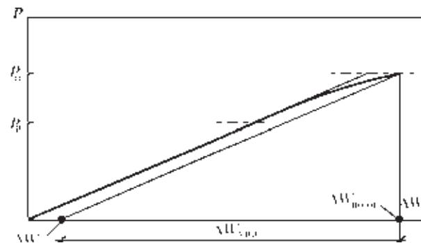
Рис. 1. Определение коэффициента остаточного расширения:
