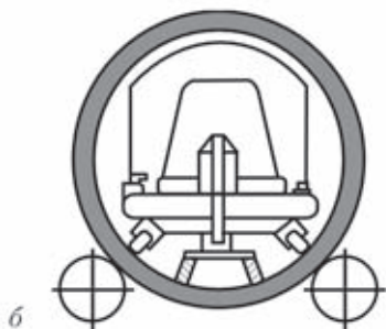
Рис. 4. Комплекты накладных вакуумных камер для листовых и угловых конструкций (а) и схема вакуумной установки для контроля герметичности сварных труб (б)
