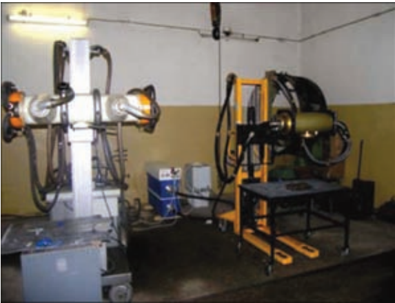
Рис. 1. Стационарные рентгеновские аппараты РУП 150/300 и «Экстравольт-360»
