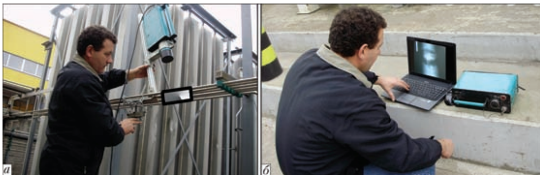
Рис. 9. Применение портативного цифрового рентгенотелевизионного оборудования: а – размещение аппаратуры на объекте; б – анализ результатов контроля на экране ноутбука
