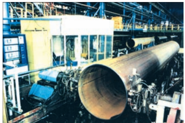
Рис. 21. Полный цикл контроля труб магистральных трубопроводов
