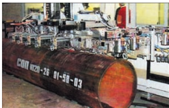
Рис. 22. Фрагмент настройки промышленных установок автоматизированного УЗК на эталонной трубе
