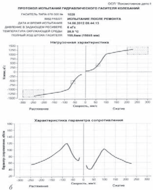
Рис. 7. Полученные при испытаниях графические зависимости между силой сопротивления P и скоростью перемещения поршня v , и между параметром сопротивления \beta и скоростью перемещения поршня v для разных типов гасителей колебаний: а – 677.000-01; б – 678.000
