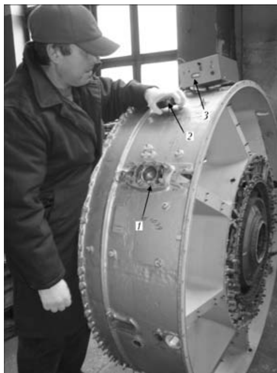
Рис. 4. ЭДО ПКА в зоне ремонтной наплавки усиления под фланец крепления трубопровода охлаждения стойки: 1 — усиление под фланец; 2 — ручной инструмент для ЭДО; 3 — источник питания для ЭДО
