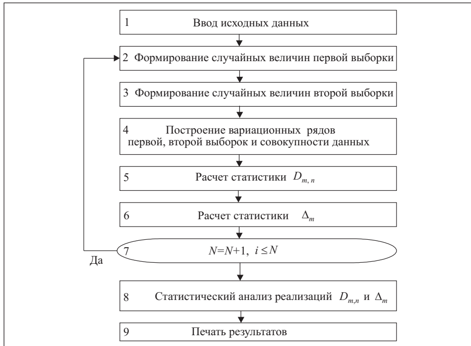
Рис. 1. Укрупненная блок-схема алгоритма оценки критических значений статистик D_{m,n} и \Delta_m
