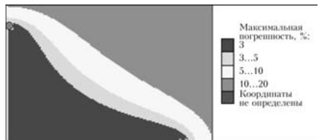
Рис. 3. Пример использования схемы отображения погрешности расчета координат источников АЭ (локация по точной формуле; погрешность расчета координат источников АЭ в пределах плоской зоны, очерченной датчиками, не превышает 3% базы антенны)
