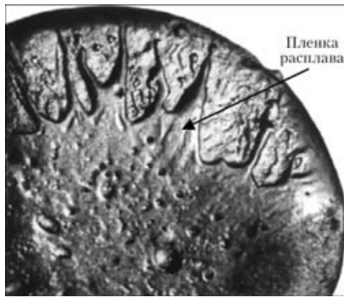
Рис. 2. Характер плавления торца стержня при термоцентробежном распылении
