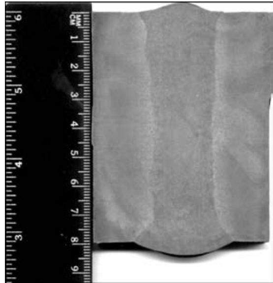
Рис. 5. Макрошлиф сварного соединения (свариваемый материал Ст 3, толщина 80 мм)
