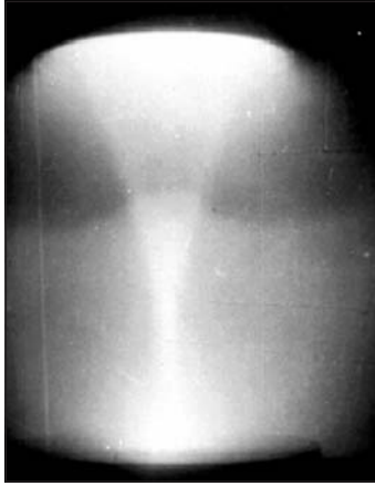
Рис. 2. Фотография разрядного промежутка: ускоряющее напряжение — 15 кВ, ток разряда — 200 мА
