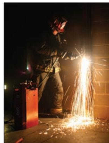
зуют для поджига стержня, который будет гореть, пока через него подается кислород. В процессе горения температура сгорания стержня достигает более 5500°C, что позволяет с легкостью разрезать практически любой материал.
