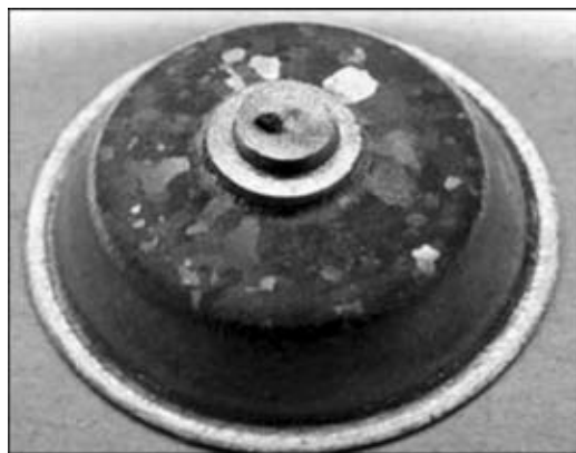
Рис. 6. Смещение ионного кратера относительно центра катода
