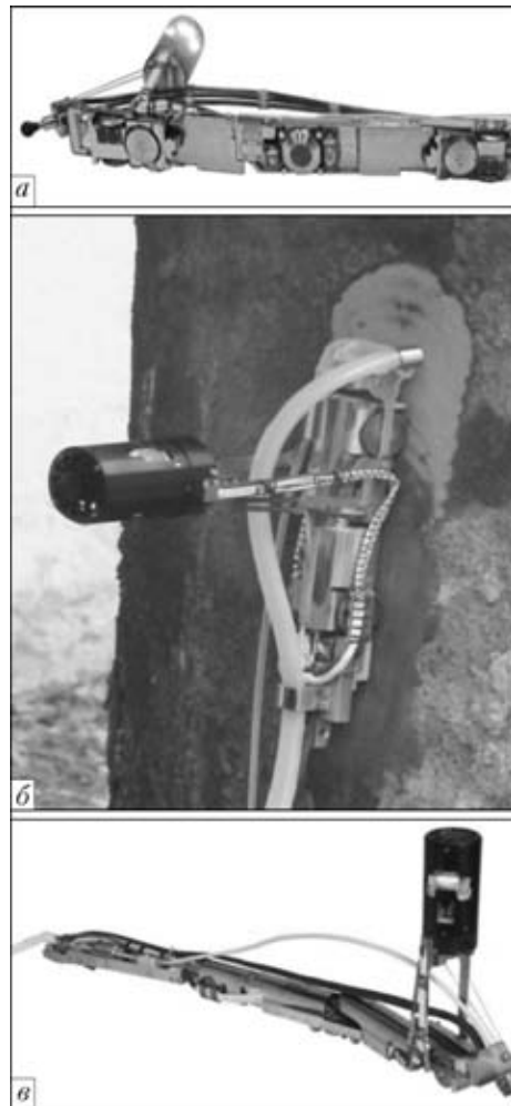
Рис. 6. Внешний вид робота с электромагнитно-акустическим сенсором (а), инструментом для абразивной зачистки (б) и сварочной горелкой (в)
