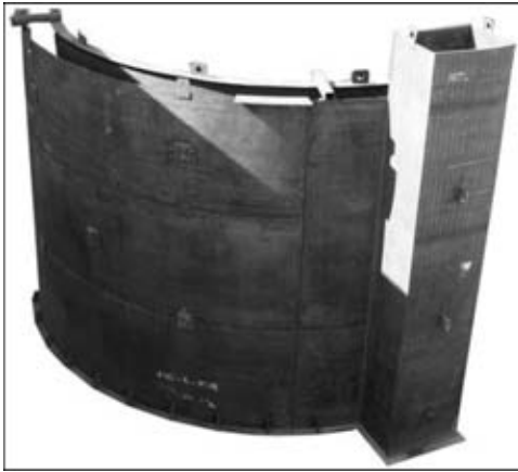
Рис. 5. Опытный стенд из стали S 223 толщиной 20 мм
