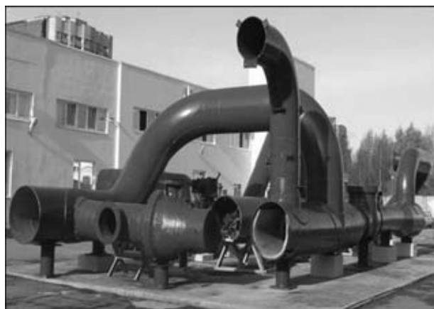
Рис. 2. Опытный стенд с искусственными и естественными дефектами
