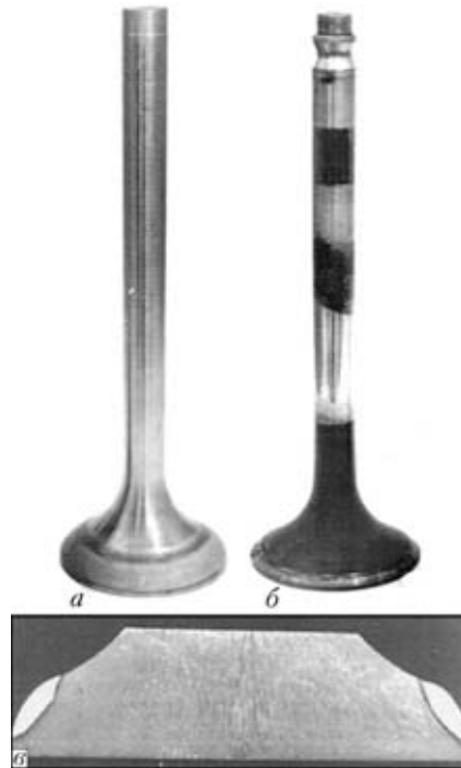
Рис. 7. Внешний вид клапана дизельного двигателя 5Д70, наплавленного плазменно-порошковым методом сплавом 50НХ25С5Р, непосредственно после наплавки (а) и после 5000 ч эксплуатации (б) и макрошлиф наплавленного клапана (в)
