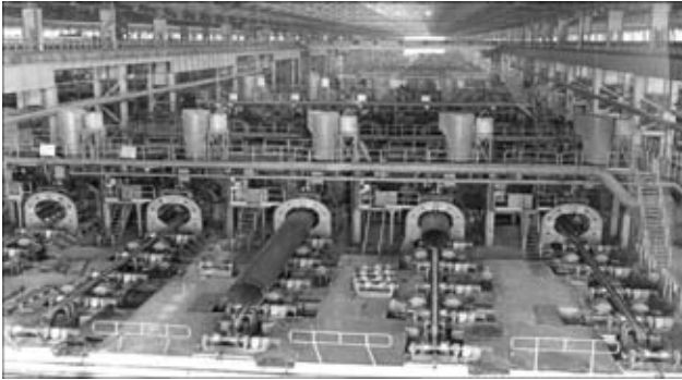
Линия автоматической сварки труб на Харцызском трубном заводе
