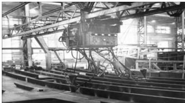
Механизированная сварка под флюсом палубного набора на Николаевском заводе «Океан»
