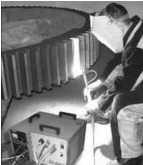
Рис. 7. Плазменная закалка зубьев крупномодульной шестерни
