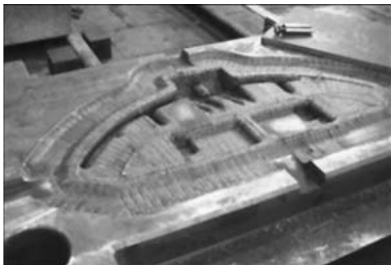
Рис. 3. Штамп сложной формы после плазменной закалки (ООО «КУМЗ»)
