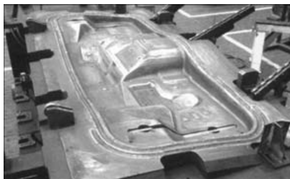
Рис. 5. Матрица автомобиля ГАЗ после плазменной закалки прижимного контура
