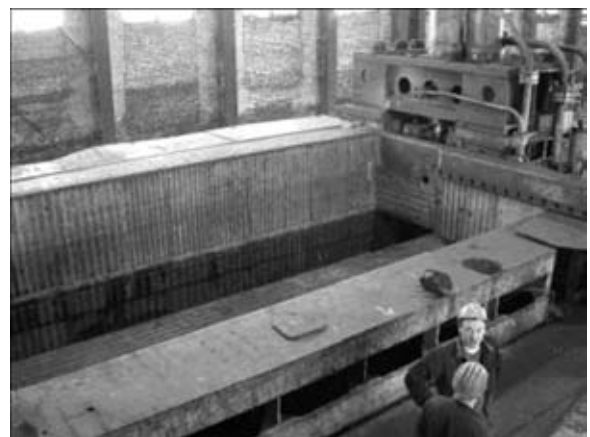
Рис. 9. Бункер пресс-ножниц, футерованный листами после упрочнения плазменной закалкой
