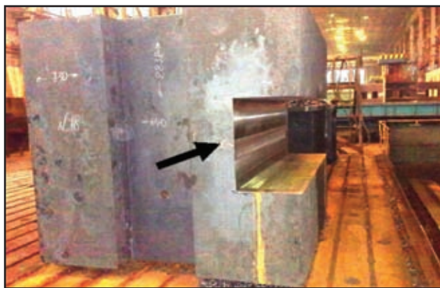
Рис. 4. Внешний вид заготовки, подготовленной для сварки способом ЭШС кованого имплантата в литую заготовку основания шабта
