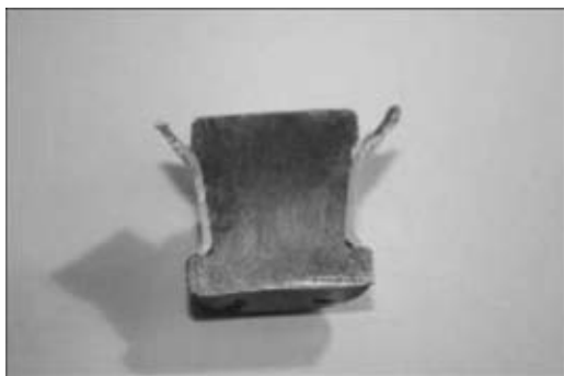
Рис. 7. Фрагмент поперечного сечения медноалюминиевого соединения (диаметр 25 мм)
