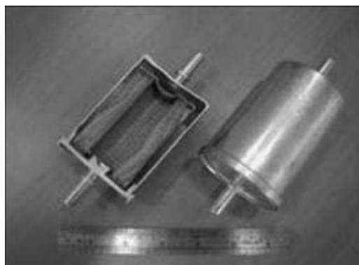
Рис. 9. Топливный фильтр, изготовленный с помощью МИС
