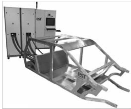
Рис. 3. Первая в мире легковесная рама корпуса автомобиля из разнородных металлов, изготовленная полностью с помощью МИС
