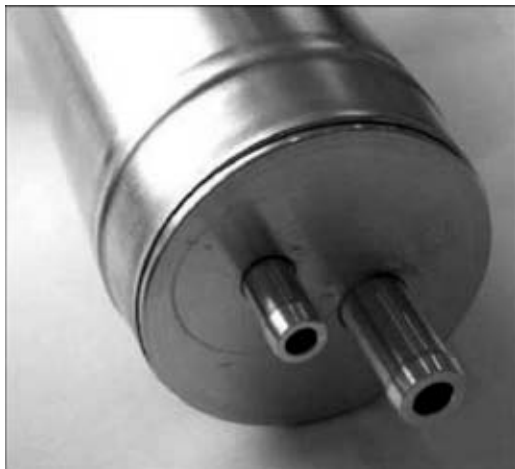
Рис. 6. Ресивер автомобильного кондиционера, сваренный с помощью МИС
