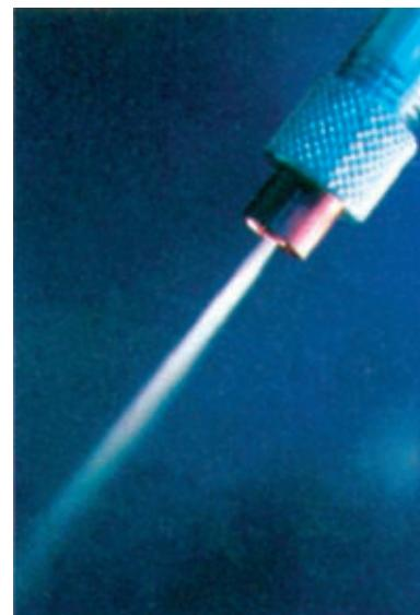
дающий механизм с высокой точностью позволяет непрерывно распределять порошок и направлять его прямо к сварочной головке. Увеличив количество порошка, можно сваривать изделия даже при больших зазорах между кромками.
