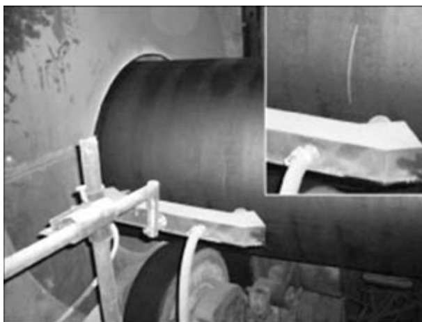
Рис. 3. Телевизионный сенсор, сканирующий поверхность вращающейся трубы
