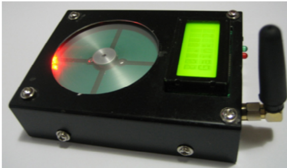
Рис. 4. Внешний вид компактного цифрового измерителя электрической напряжённости поля
