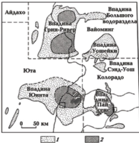
Рис. 1. Обзорная схема размещения горючих сланцев типа Грин-Ривер (по данным Департамента внутренних дел США, 1973): 1 — район развития неогенных либо низкосортных горючих сланцев; 2 — район развития сланцев мощностью более 3 м с выходом сланцевого масла 95 л/т и больше.
