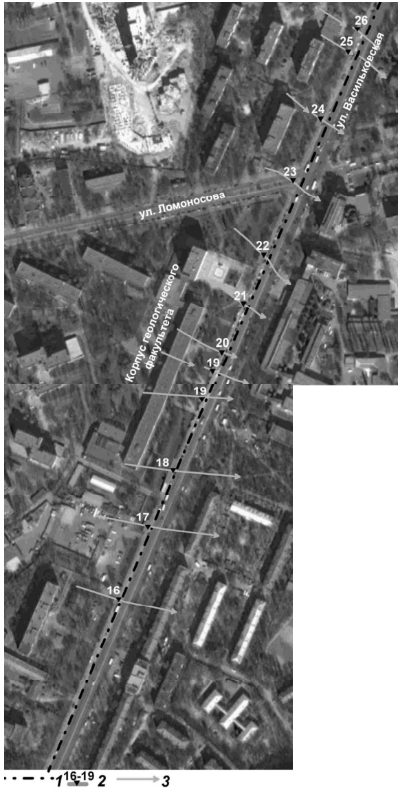
Рис. 1. Схема расположения зон повышенной фильтрации грунтовой воды и направленной миграции подземных водных потоков № 16–26 (потоки № 18–20 проходят в районе расположения здания геологического факультета Киевского национального университета имени Тараса Шевченко): 1 – линия проведения вертикального электрорезонансного и георадарного зондирования; 2 – участки зон повышенного увлажнения грунтов № 16–26; 3 – направление миграции подземных водных потоков
