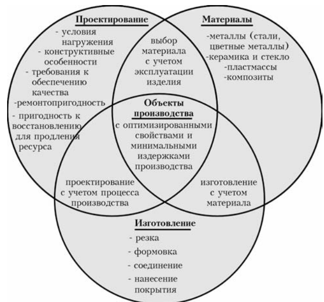
Рис. 1. Взаимозависимость между конструкцией, материалом и способом изготовления, определяемая технологией соединения [1]
