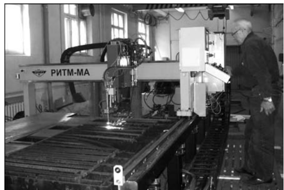
Рис. 10. Комбинированная порталная МТР с односторонним приводом и шириной обрабатываемого листа до 2 м
