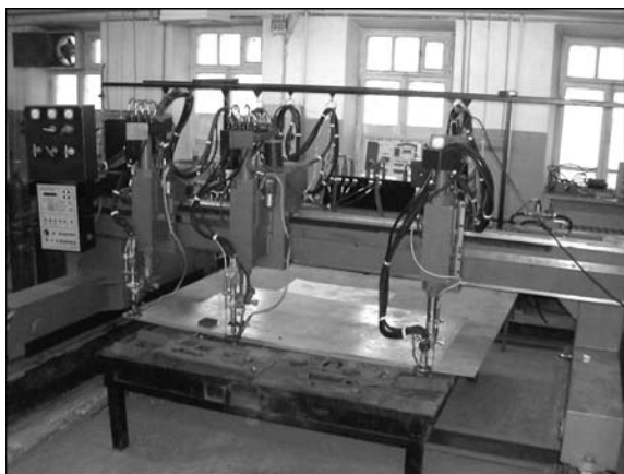
Рис. 6. Портальная МТР с двумя кислородными и одним плазменным резаком
