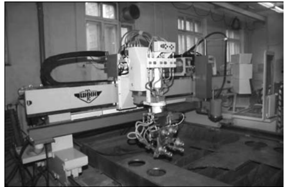
Рис. 9. Комбинированная МТР, оснащенная плазменным модулем и трехрезаковым газовым блоком, с шириной обрабатываемых листов до 2,5 м
