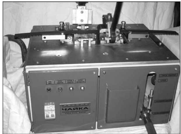
Рис. 2. Машина МКССО-60Б для сварки ленточных пил
